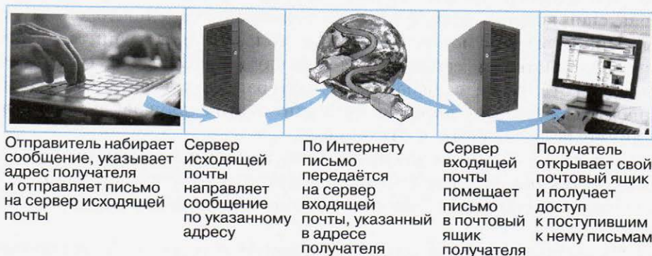
Рис. 4.5. Схема работы электронной почты
