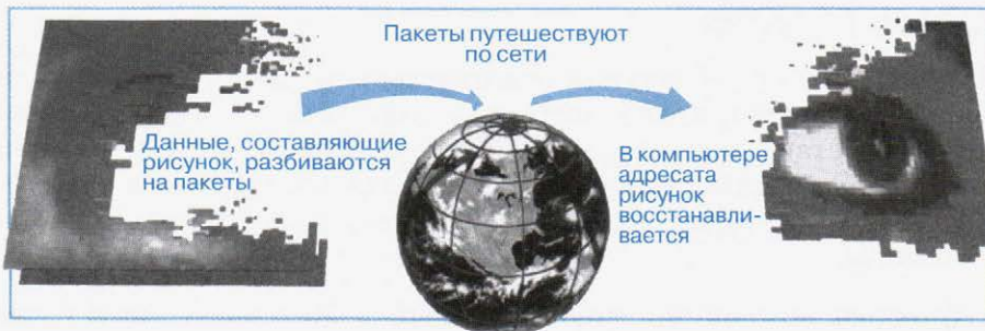
Рис. 4.4. Пакетная передача данных
